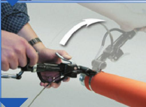
Band in das Spannwerkzeug seitlich einführen, Excenterhebel andrücken, und durch Drehen der Kurbel Schelle anziehen. Die maximale Spannung ist erreicht, wenn das Band nicht mehr unter der Schlaufe durchzieht.
